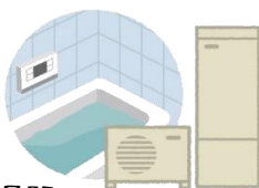
給湯器 エコキュートの設置
